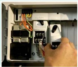
Actualiza fácilmente entre 4 y 13 estaciones, con el agregado de módulos de 3 estaciones al momento de la instalación, o en el futuro.
